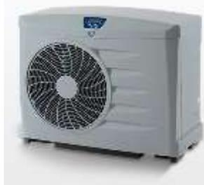
Pompa di calore aria/acqua monoblocco, adatta a piscine fino a 70 mc. Regolatore a display digitale, scambiatore condensatore ad acqua in titanio, sbrinamento automatico (inversione del ciclo), compressore rotativo a palette, fluido refrigerante R32, flussostato, sicurezza pressostato alta e bassa pressione, termostato antigelo (temperatura minima di funzionamento -5°C).
