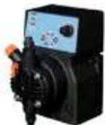
Pompa dosatrice analogica modello DLX-MA/AD con regolazione della portata manuale mediante variazione della frequenza, campo di regolazione 0÷100% su doppia scala di regolazione. Completa di kit corredo standard (aspirazione/mandata). Predisposizione per la sonda di livello opzionale.
