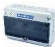
Quadri elettrici con protezione della pompa e controllo fari con differenziale MF. Composto da: contenitore stagno (IP65) 16 moduli, protezione magnetotermica, orologio di programmazione 24H, interruttore 3 posizioni, uscita protetta controllo fari.
